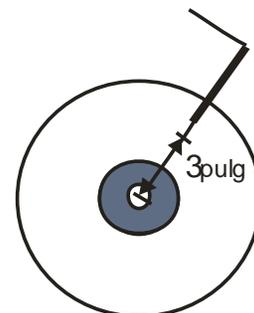
$$\omega = \frac{33\frac{1}{3} \text{ vueltas}}{\text{minuto}} = \frac{100 \text{ vueltas}}{3 \text{ minutos}} \cdot \frac{2\pi \text{ radianes}}{\text{vueltas}} = \frac{200\pi \text{ rad}}{3 \text{ minutos}}$$
